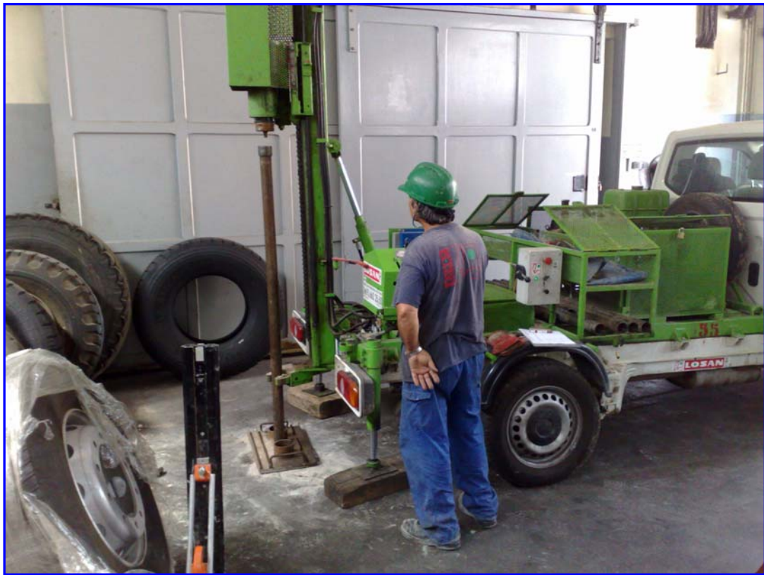
Figura 1: Realització del sondeig a percussió P-1.
